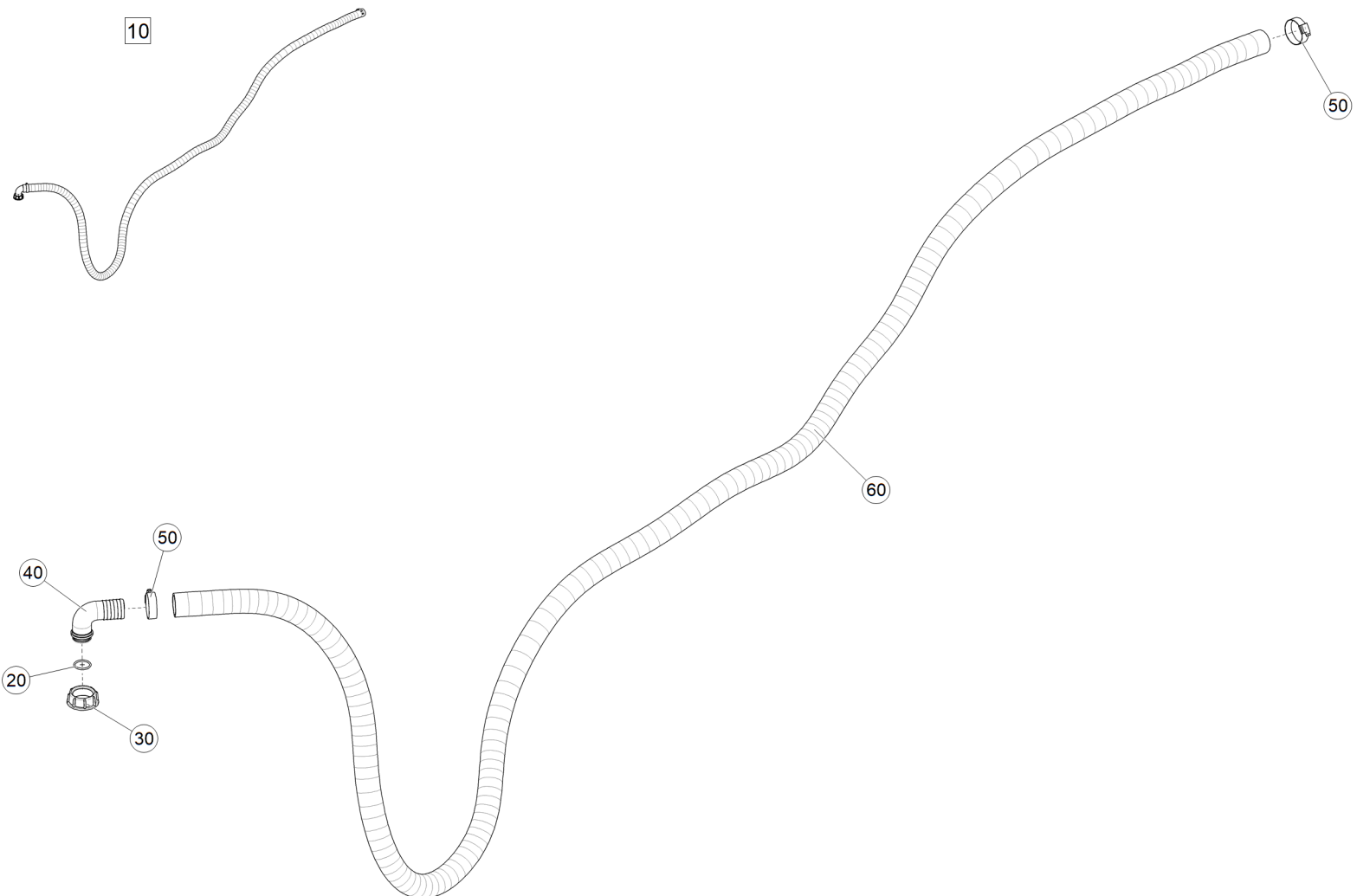
Рис. 1 ETB-6000000309 (Шланг сливной GESTAENGE)
